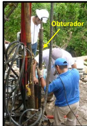
Fotografías 14, 15, 16 y 17. Equipo necesario para ejecutar las pruebas de permeabilidad.
