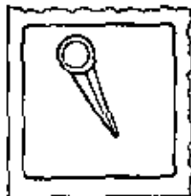
Posición de "DISPARO" (desconexión): Cuando el interruptor dispara automáticamente debido a una sobrecarga o corto-circuito.
