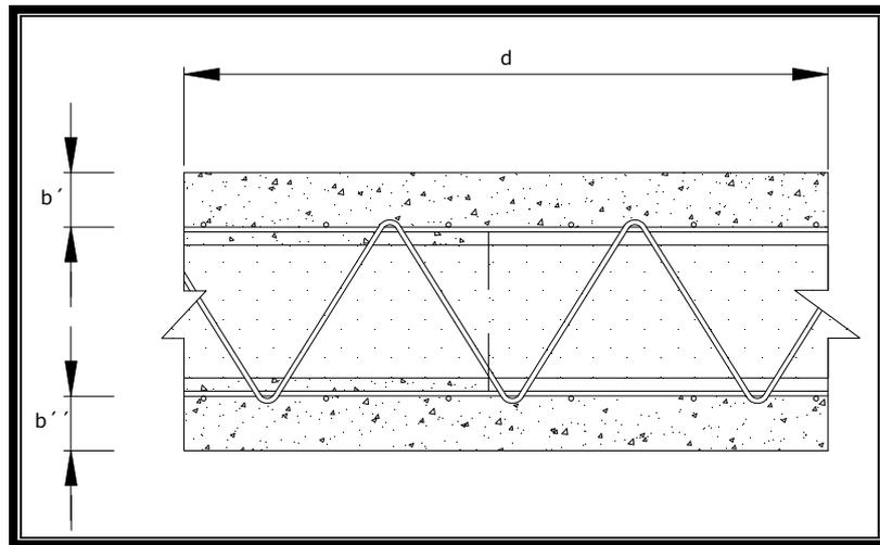
$b' = b''$  Ancho del mortero a ambos lados del panel (entre 2.5 y 3.5cm).
