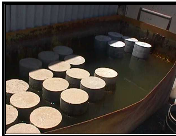
Fig. 2.43 Se debe curar siempre el concreto para que alcance su máxima resistencia
