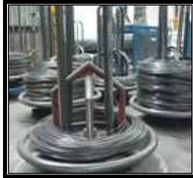
Figura 1.1 Acero para la fabricación del panel estructural
