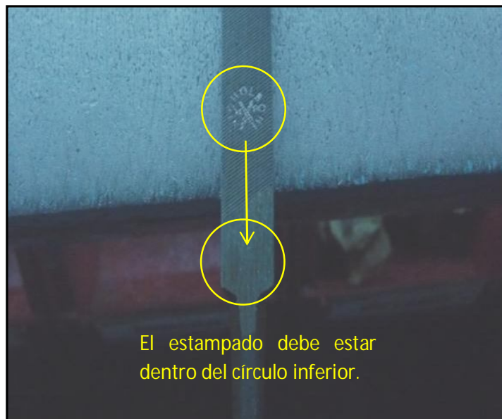
Figura 4.4 Posición del estampado incorrecto
