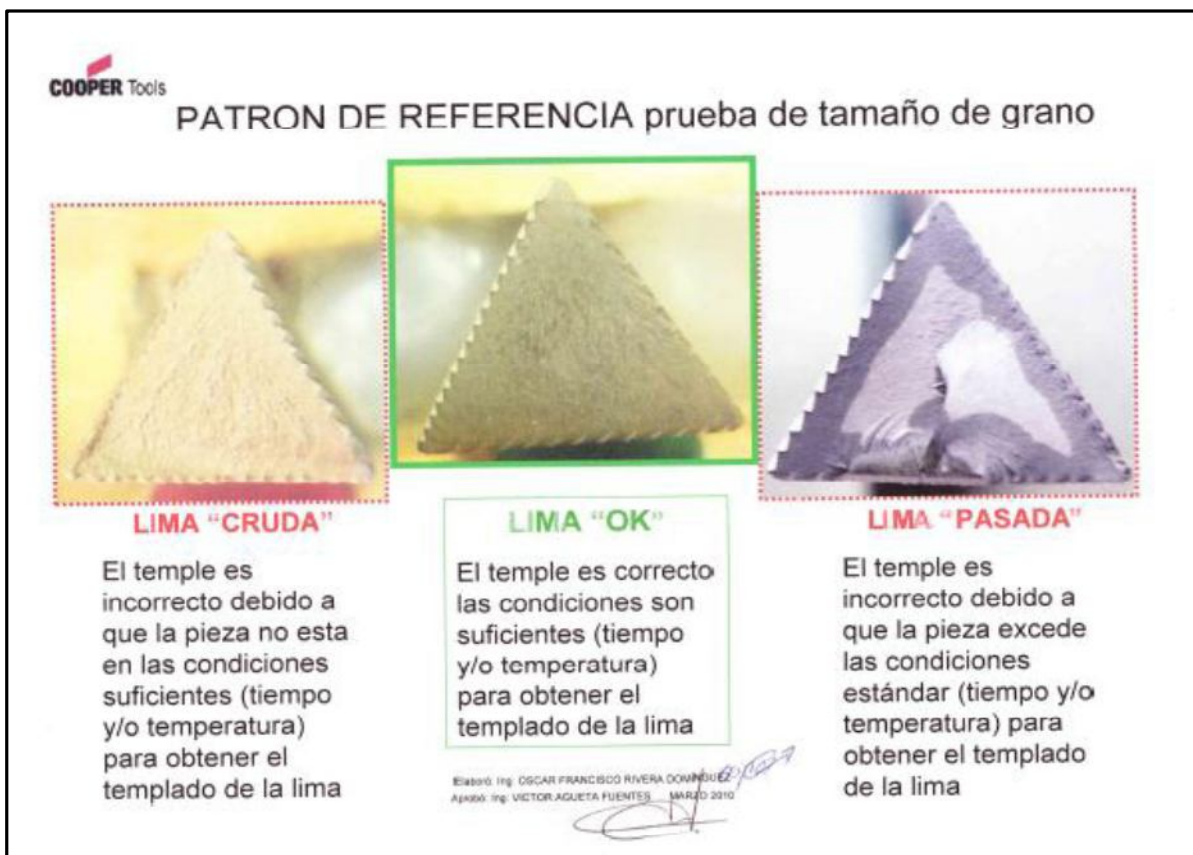
Figura AG.0.1 Patrón de Referencia prueba de tamaño de grano
