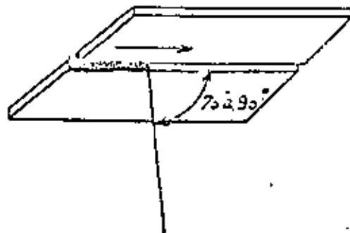
FIG. V-II.- METODO DE SOLDADURA EN TECHO.
