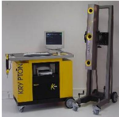
**Fig. 1.35. Cámara receptora, y modulo de adquisición de datos del sistema Krypton-600<sup>6</sup>**
