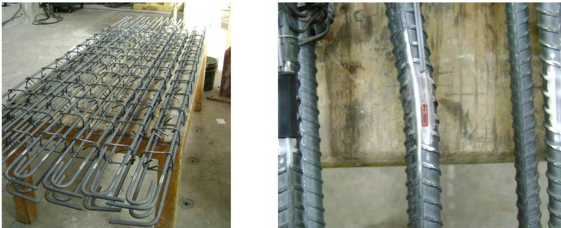
*Fig. 1.30. Colocación de las galgas en los las varillas de los castillos.*
