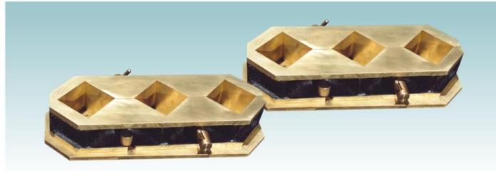
*Fig. 1.19 Moldes de bronce para muestras de mortero<sup>4</sup>.*
