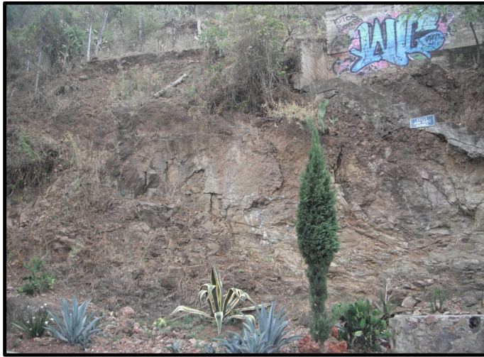
Figura 3.35 Plano de falla La Paloma, con abundante fracturamiento, la calidad de la roca es de menor calidad, aunque se encuentra intemperizada.
