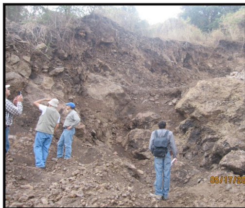
Figura 3.31 Composición del material de deslizamiento, derrames de andesita con brecha volcánica, ignimbritas y tobas.
