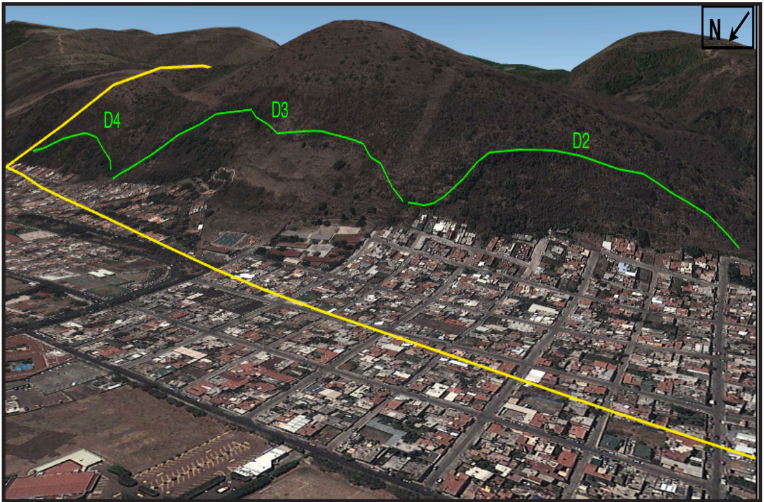
Figura 3.45 Serie de 3 deslizamientos (D2,D3 y D4) en el escarpe de la falla La Paloma, nótese lo cercano que se encuentra la zona urbanizada. En el D3 se aprecia la distancia a la cual llegó el desplazamiento en eventos anteriores y como la zona residencial esta acentada sobre material no consolidado producto del deslizamiento (Modificada de Google Earth, 2012).
