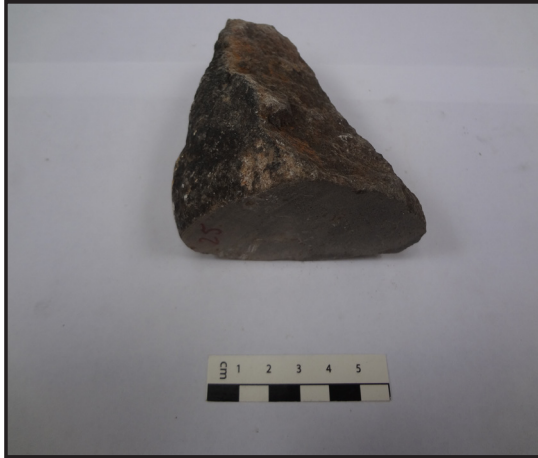
Figura 3.8 Muestra 25, andesita color gris oscuro tomada en el Río Chiquito.
