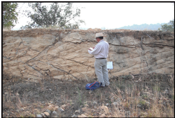
Figura 3.20 Afloramiento de ignimbrita en la zona de Altozano, Loma Larga, con presencia de abundantes fracturas.
