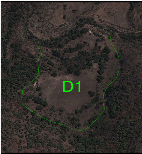
Figura 3.39 Delimitación del Deslizamiento 1, en conjunto la planicie, los eventos de deslizamiento anteriores y el comienzo de la pendiente.
