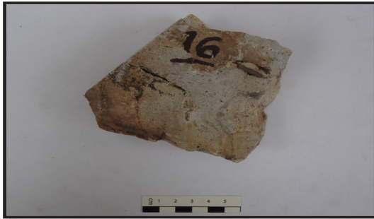
Figura 3.25 Ignimbrita color claro intemperizada, tomada en 274042 E 2176262 N, en la falla Seminario.
