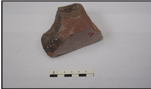
Figura 3.24 Muestra 23, Ignimbrita color rojizo claro, de muy buena calidad, tomada en el punto 274556 E 2176533 N en la Loma cercana al deslizamiento 1.
