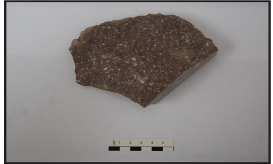
Figura 3.23 Cara fresca de la muestra 29, la ignimbrita es de color rosaseo, con cristales de cuarzo, y plagioclasa.
