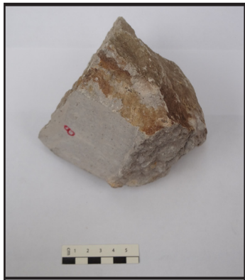
Figura 3.28 Muestra 8 tomada de la unidad de tobas arenosas en el punto 272919 E 2177098 N, cerro Loma Larga, diferencia entre el color gris claro al fresco y el el intemperisado mas amarillento.
