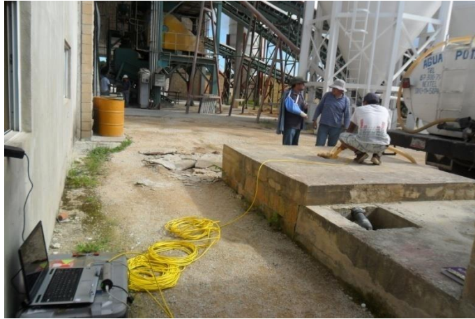
Foto 12. Inyección de agua en el pozo “Tiger”
