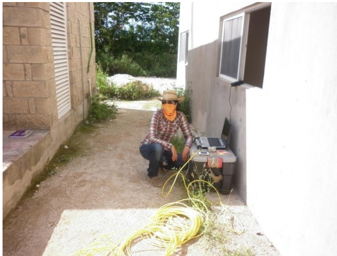
Foto 11. Prueba tiposlug en el pozo “Tiger”
