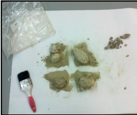
Fig. 2.2. Preparación de una muestra en el laboratorio (homogenizada y cuarteada).
