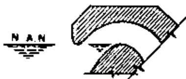
FIG. 8.-ENTRADA DE AIRE CON EL LABIO SUPERIOR AL NIVEL AGUAS NORMALES.
