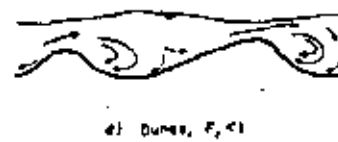
Configuraciones posibles del fondo de los cauces naturales, formados con material granular
