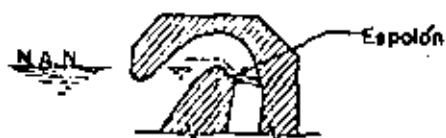
FIG. 13.-CIERRE HIDRAULICO POR LA LAMINA VERTIENTE
