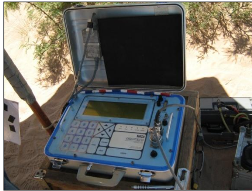
Figura 2.5. Equipo Sirotem utilizado para el trabajo
