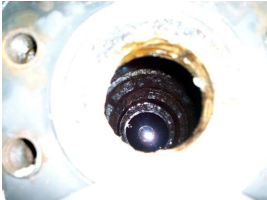
FOTOGRAFÍA 4.15 MEZCLA PETROLEO-AGUA ENCONTRADO EN EL TUBO CENTRAL DEL POZO DE PRODUCCIÓN
