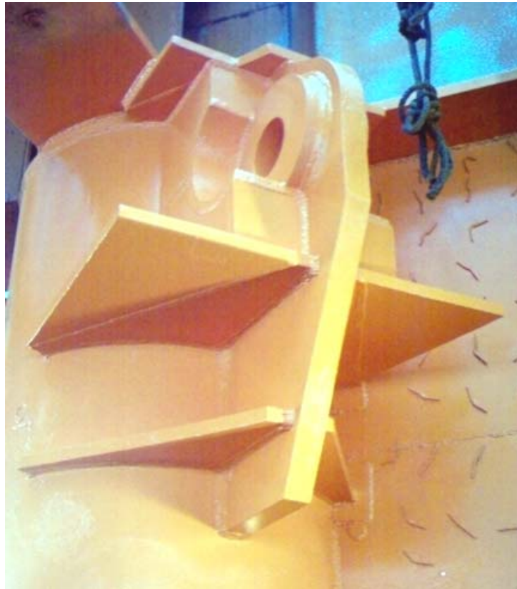
FOTOGRAFÍA 4.40 PRESENTACIÓN FINAL DE LAS OREJAS DE IZAJE REFORZADAS
