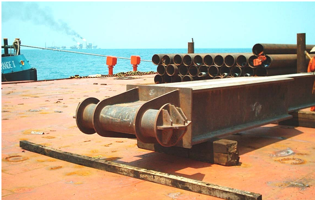
FOTOGRAFÍA 4.29 DETALLE DEL ELEMENTO DE TRACCIÓN PARA EL ARRASTRE EN PATIOS.
