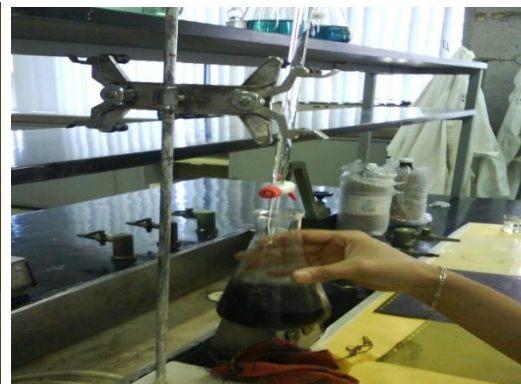
Figura 3.14. b) Difelinamina y agitación para producir la coloración para la titulación
