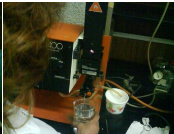
Figura 3.16.f) Limpieza con ácido nítrico
