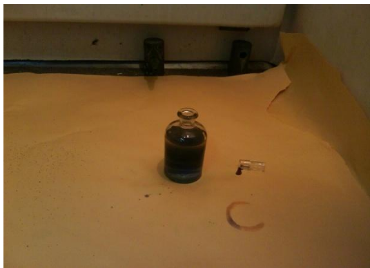
Figura 3.14. b) Difelinamina y agitación para producir la coloración para la titulación
