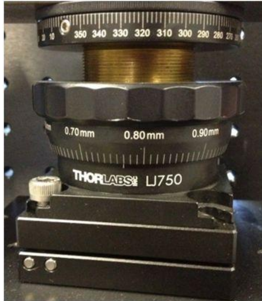
Figura 23. Bases de metal con base giratoria para el desplazamiento vertical.
