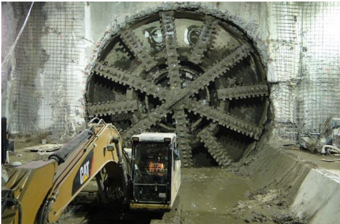
Figura 41. Escudo de Presión Balancead (EPB).
