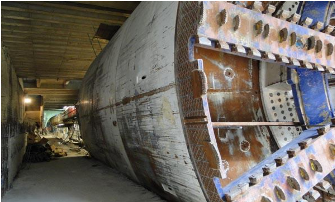
Figura 39. Escudo de Presión Balanceada ( EPB ).
