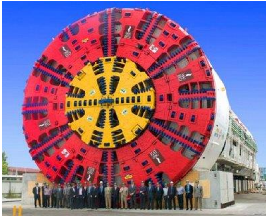
Figura 26. Escudo de presión balanceada.
