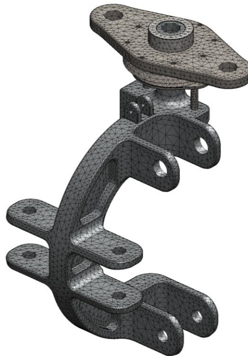
Fig. 114. Malla para el análisis de elemento finito del bogie (AEF). (Elaboración propia)
