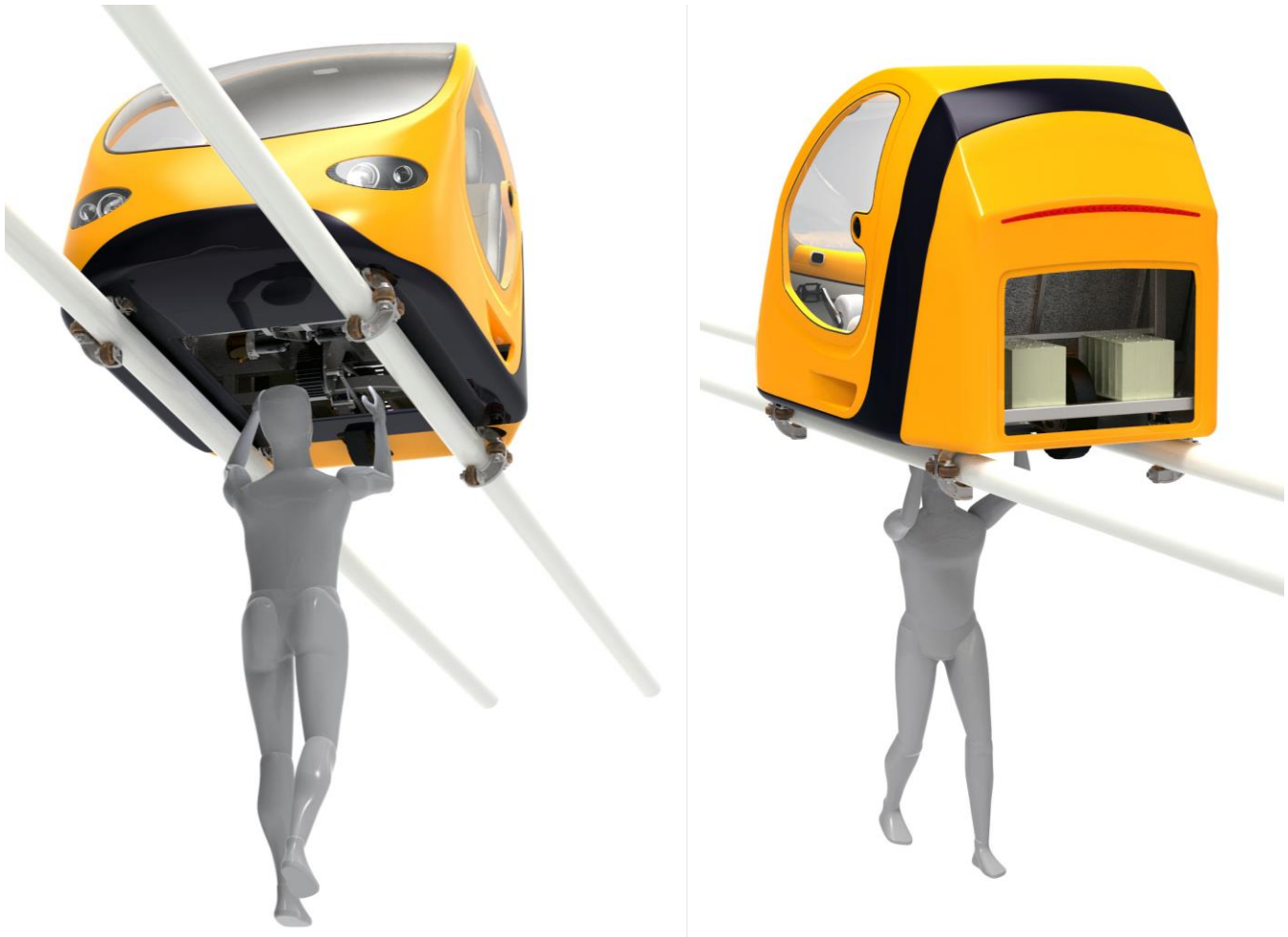
Fig. 178. Paneles removibles para el mantenimiento. El panel inferior facilita las tareas de mantenimiento pues se puede realizar el servicio sin remover el vehículo de la vía. (Elaboración propia)
