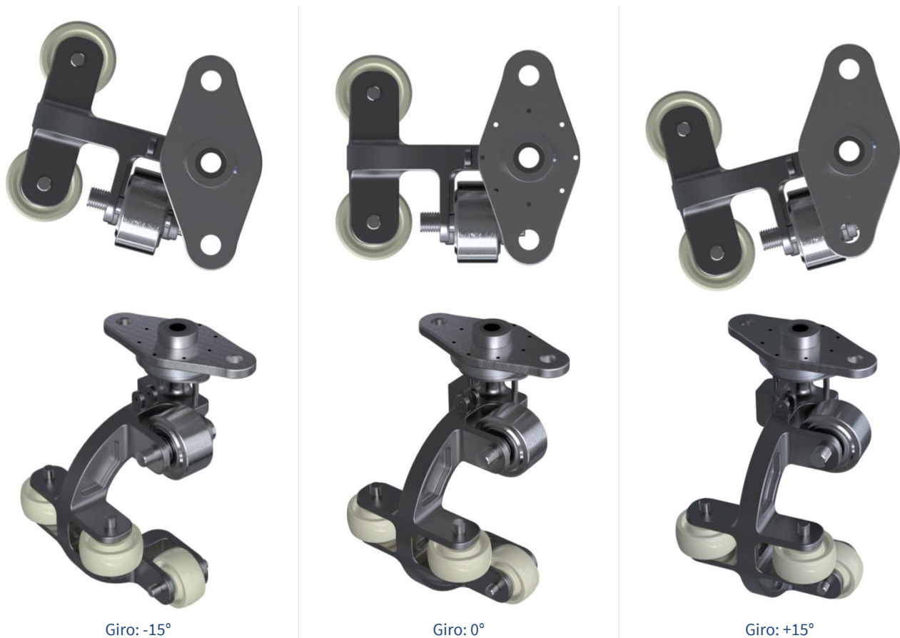
Fig. 107. Ilustración del mecanismo de articulación del bogie. (Elaboración propia)
