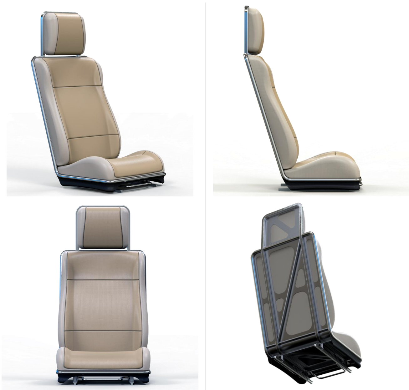
Fig. 92. Varias vistas del ensamble del asiento. (Elaboración propia)
