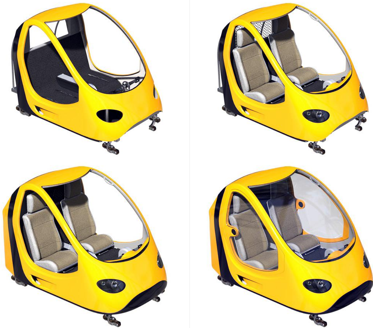
Fig. 187. Proceso esquemático del ensamble del vehículo completo. (Elaboración propia)
