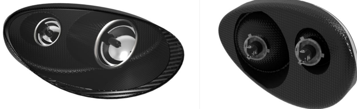
Fig. 179. Render de los focos frontales del vehículo. Los soportes están diseñados para recibir cualquier foco comercial. En el render se muestran cuatro focos Hella 55W H83115001. (Elaboración propia)
