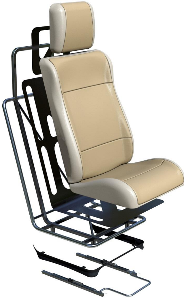
Fig. 94. Proceso esquemático de ensamble del componente asiento. (Elaboración propia)
