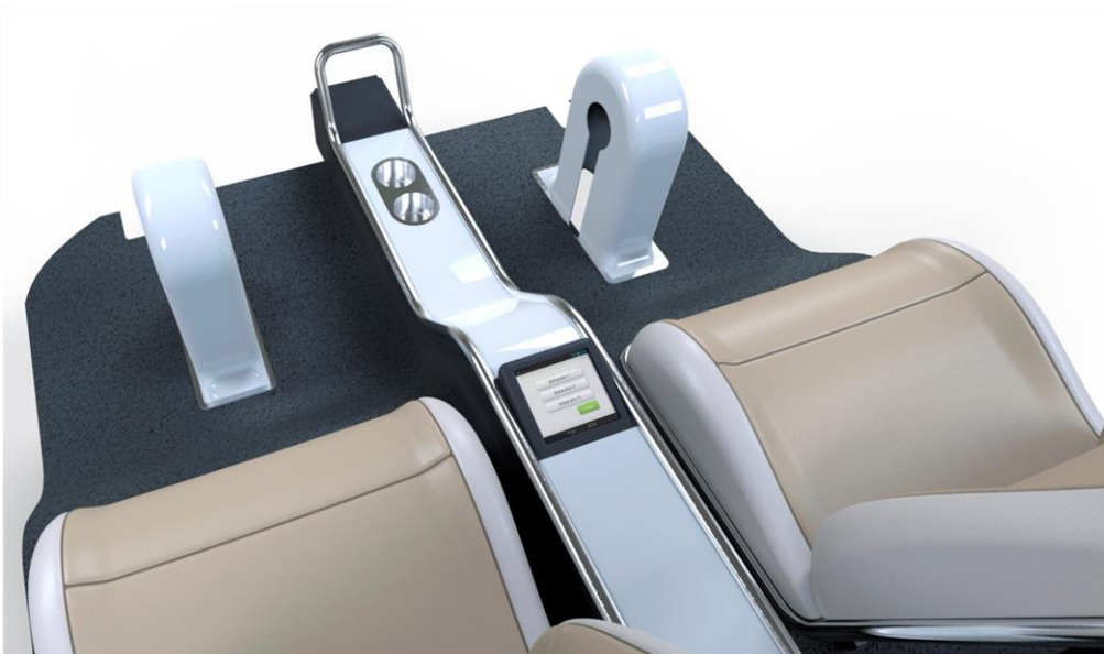
Fig. 100. Render de la consola central mostrando la pantalla de control del vehículo. (Elaboración propia)
