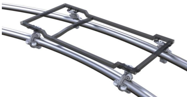
Fig. 155. Simulación de avance en Solidworks 2011, para un vía aleatoria. (Elaboración propia)
