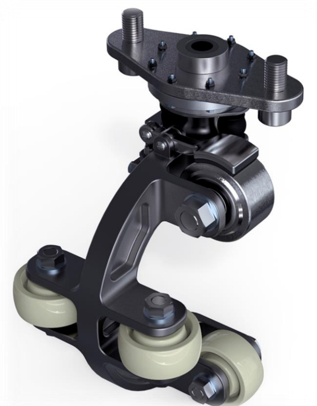
Fig. 122. Render del ensamble completo del bogie. (Elaboración propia)
