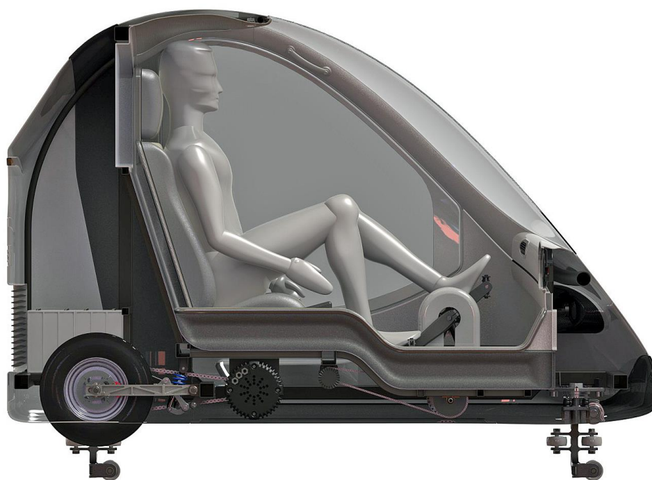
Fig. 190. Corte transversal del vehículo, con un pasajero de 193.0 [cm] de estatua correspondiente al 99 percentil mundial. (Elaboración propia)
