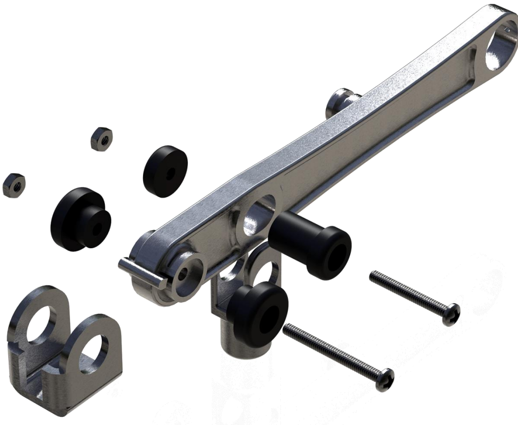
Fig. 80. Vista explosiva del ensamble de la palanca del riel. (Elaboración propia)
