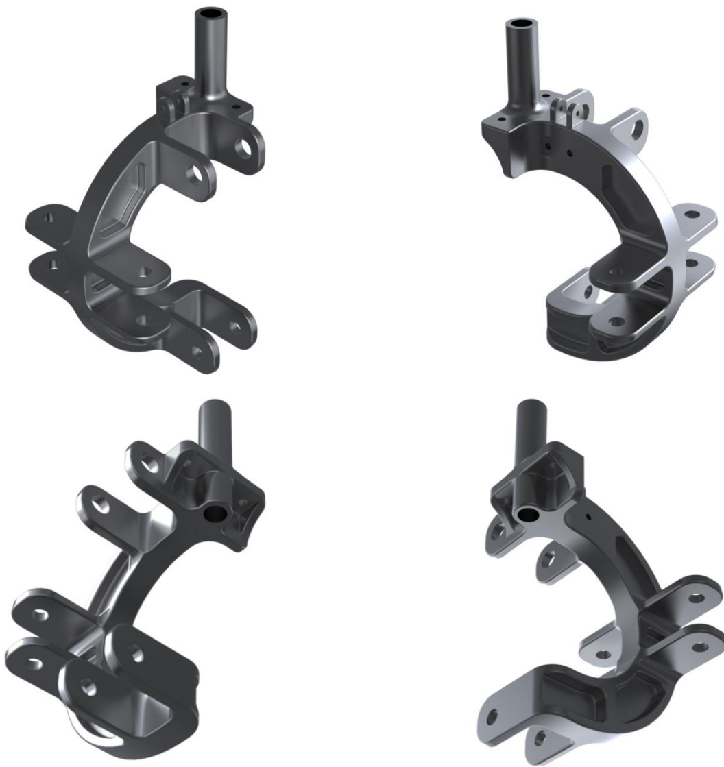
Fig. 105. Varias vistas del soporte principal del bogie. (Elaboración propia)
