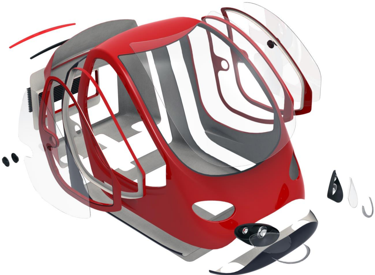
Fig. 182. Vista explosiva del ensamblaje de la carrocería. (Elaboración propia)
