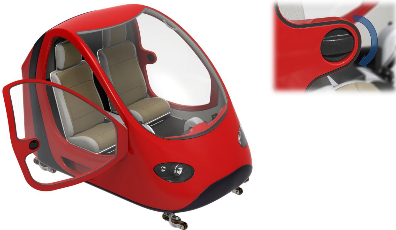
Fig. 180. Render del vehículo con la puerta de acceso abierta. Se muestra en detalle la manija rotativa para la apertura de la puerta. (Elaboración propia)
