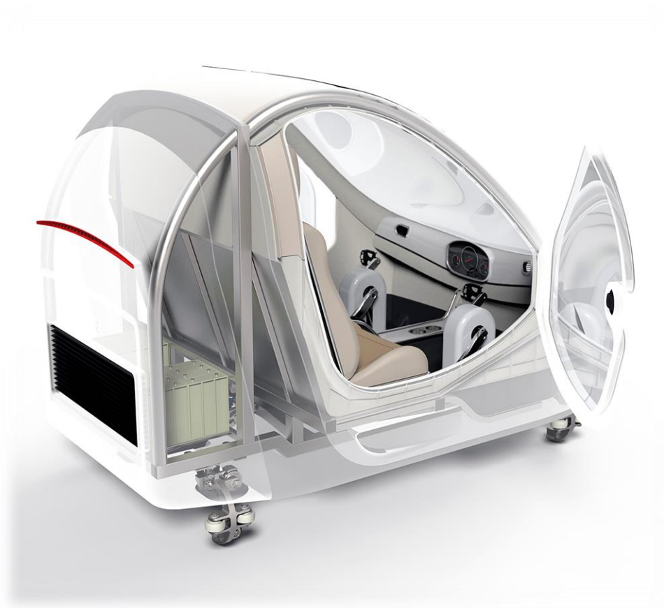
Fig. 189. Distribución de espacios y elementos en el vehículo. (Elaboración propia)
