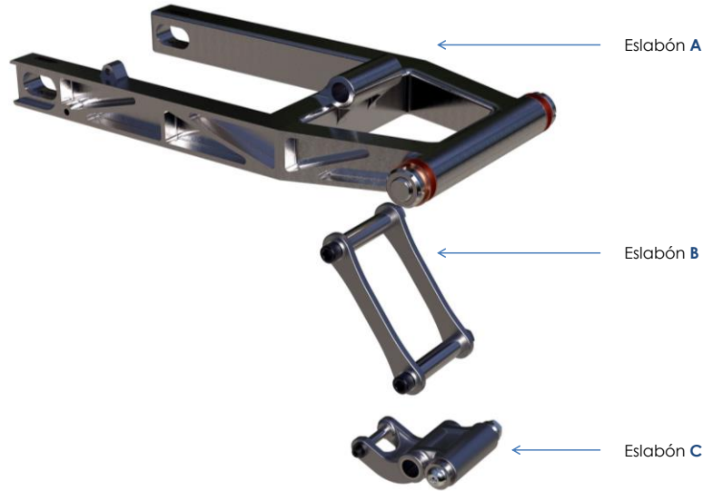
Fig. 129. Render de los eslabones de la suspensión. (Elaboración propia)
