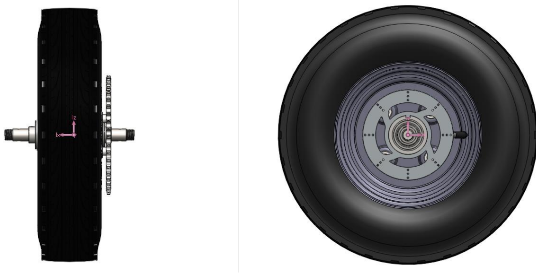
Fig. 153. Centro de masa (ejes rosas) de la masa y rueda neumática. (Elaboración propia)
