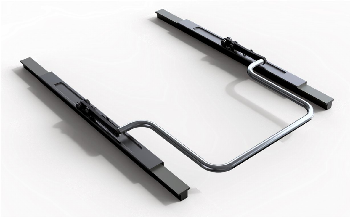
Fig. 81. Mecanismo duplicado en los dos rieles, unidos por una barra metálica AISI 304. (Elaboración propia)
