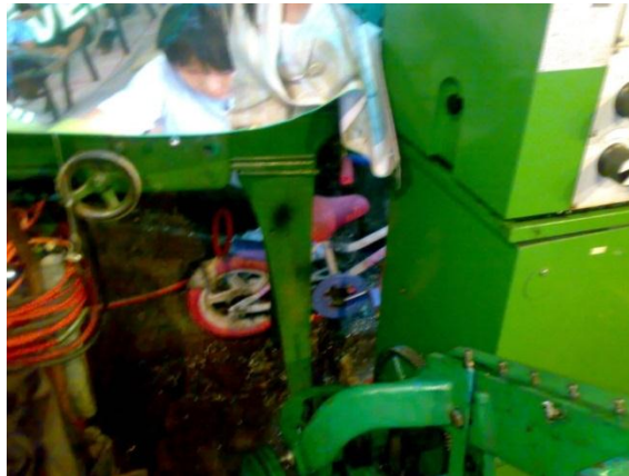
Figura 13-Falta de orden y limpieza torno
