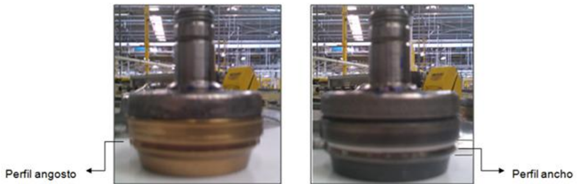
FIGURA 27. Perfiles de las carretillas.
