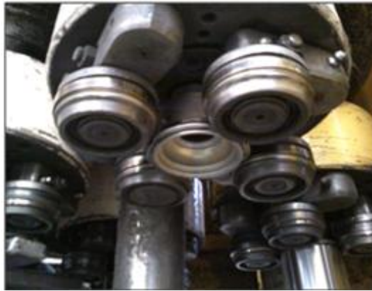
FIGURA 45. Exceso de juego en el eje del cabezal de cierre.
