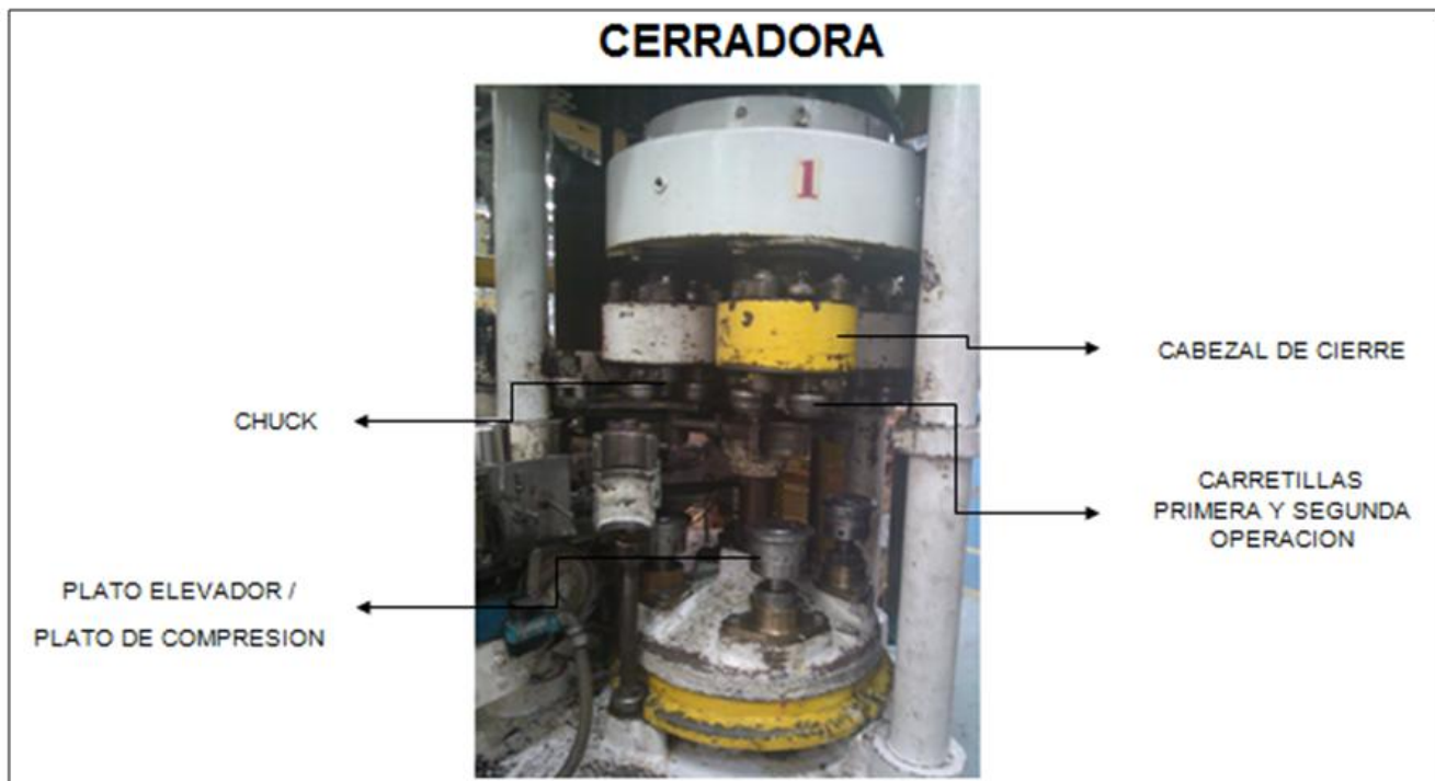
FIGURA 9. Partes fundamentales de una cerradora de envases metálicos.
