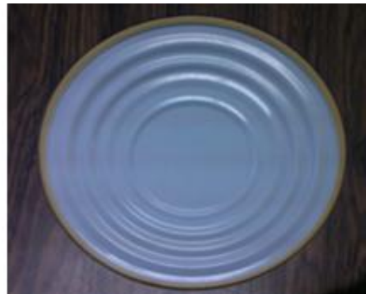
FIGURA 53. Exceso de compuesto sellador.
