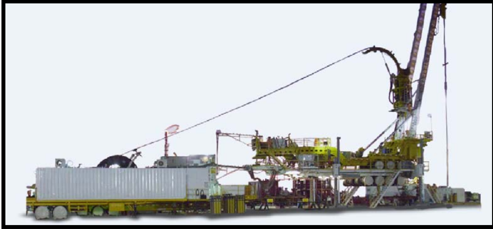
Figura 3. 3. Unidad de Perforación con Tubería con capacidad para TF de 2" 7/8.
