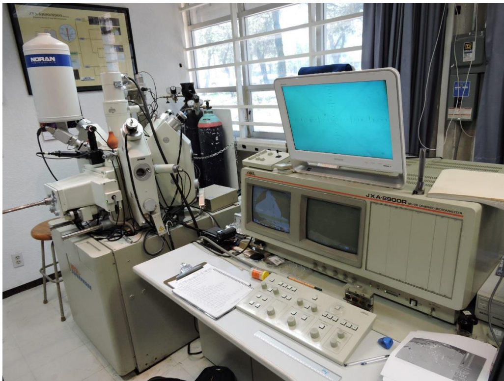
Figura 2. Microsonda JEOL JXA8900-R del Instituto de Geofísica.
