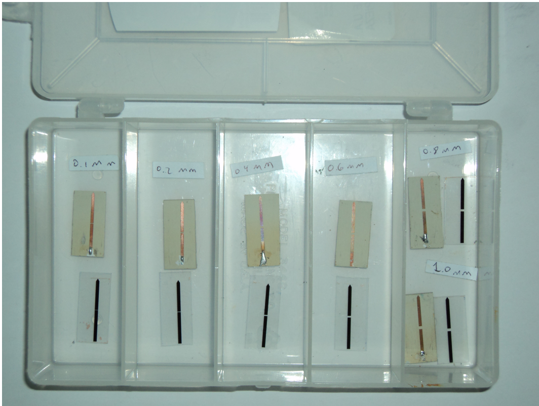
Figura 3.2: Resonadores fabricados y las máscaras empleadas
