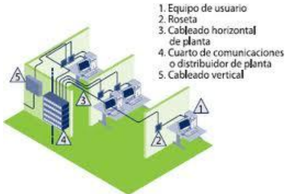
Figura 4.1.4 Componentes del cableado estructurado
