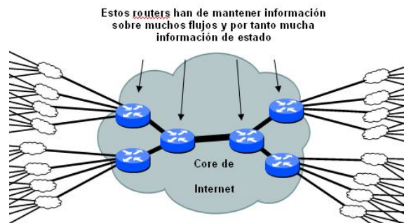
Fig. 7.4 Esquema de routers con información de red
