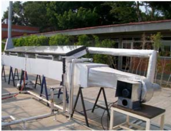
Ilustración 29. Secador solar de arroz en el CIE UNAM [autor], el aire se puede calentar directamente al pasar los colectores solares o través de agua caliente calentada con colectores solares.
