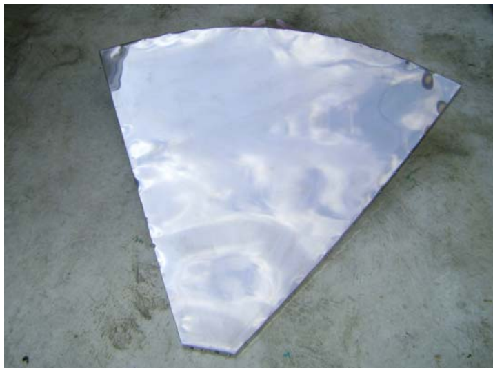
Ilustración 123. Vista frontal de gajo terminado a 45 grados.
