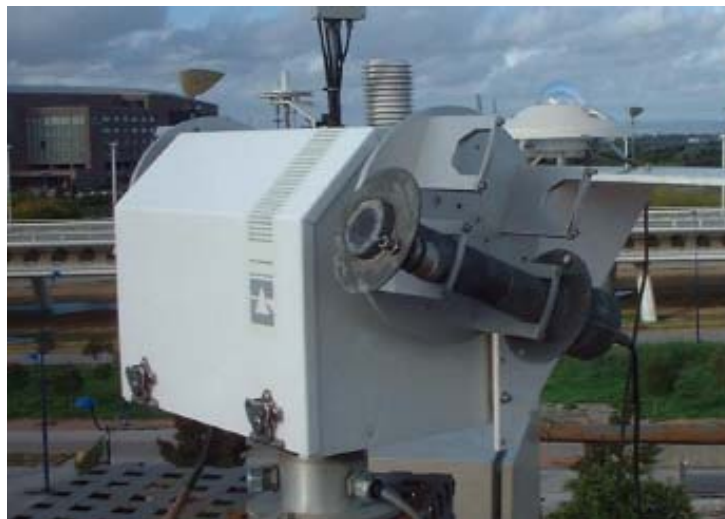
Ilustración 69. Piroheliómetro EPPLEY NIP (Ruíz, 2006).
