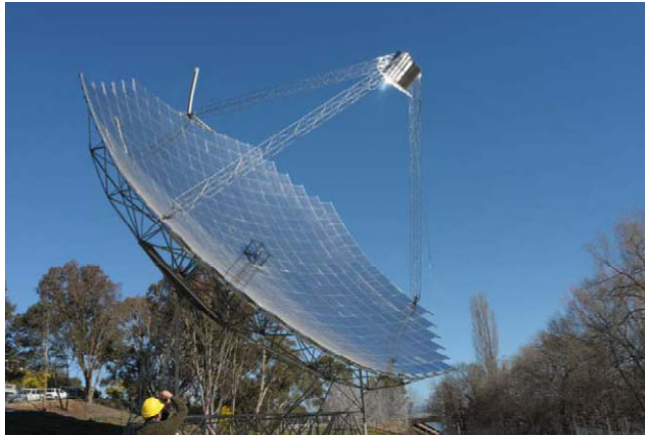
Ilustración 49. Superficie receptora conformada de diversos espejos (Lovegrove, 2008).
