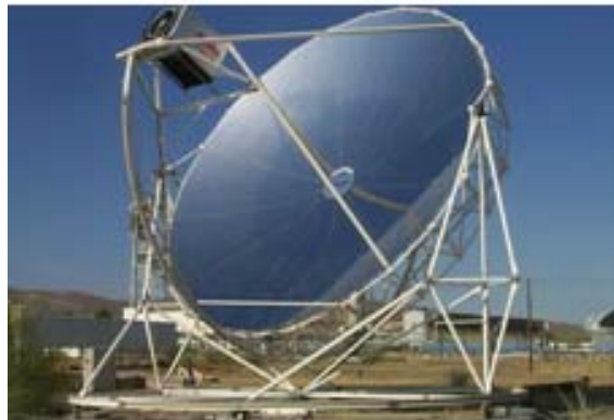
Ilustración 25. Concentrador de disco parabólico. El receptor de la energía solar es puntual y se localiza en el foco de la parábola (Pillatowsky, 2009).
