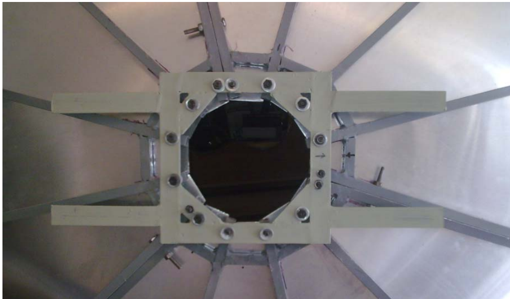
Ilustración 136. Brida de sujeción hacia el mecanismo de movimiento.
