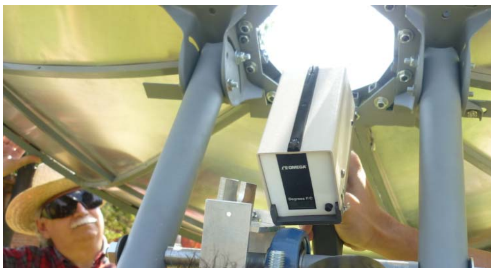
Ilustración 146. Medición de la temperatura alcanzada (402 °C).
