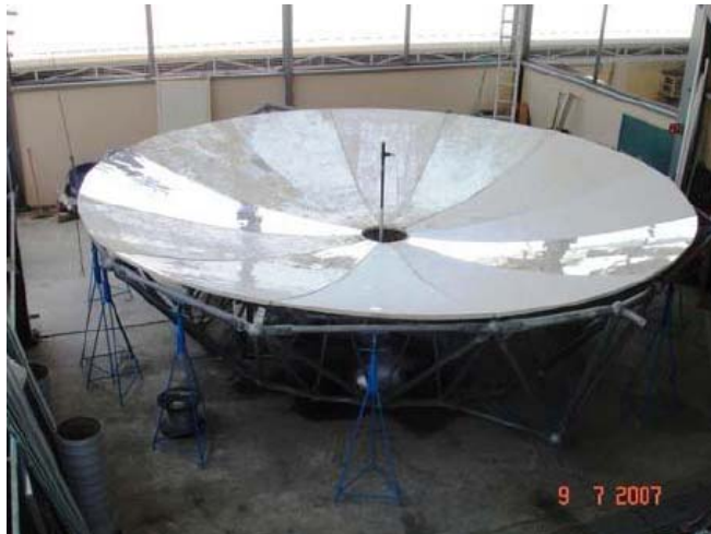
Ilustración 55. Concentrador solar de disco parabólico, construido en el Instituto de Investigaciones Eléctricas (Ramirez, 2007) .
