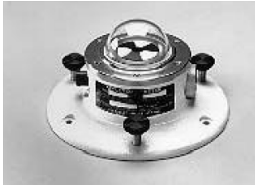
Ilustración 66. Foto de un piranómetro (Juan Hermosillo, 1995).
