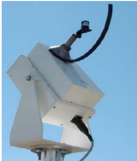
Ilustración 67. Piranómetro con sistema de sombra para radiación difusa. (Ruíz, 2006).
