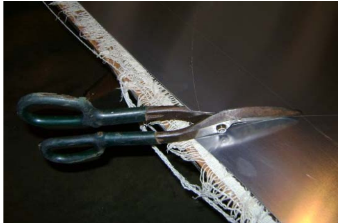
Ilustración 128. Cortes al sustrato de aluminio.
