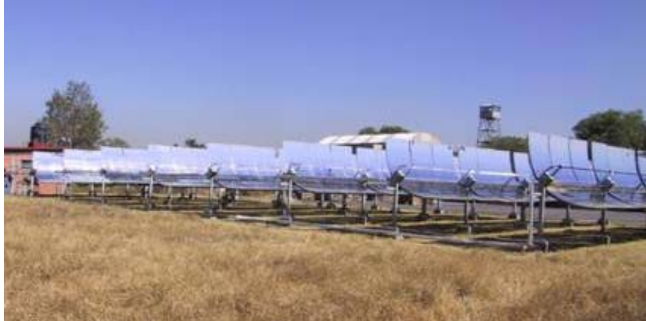
Ilustración 43. CPCs en la planta solar del Instituto de Ingeniería de la UNAM (el autor).
