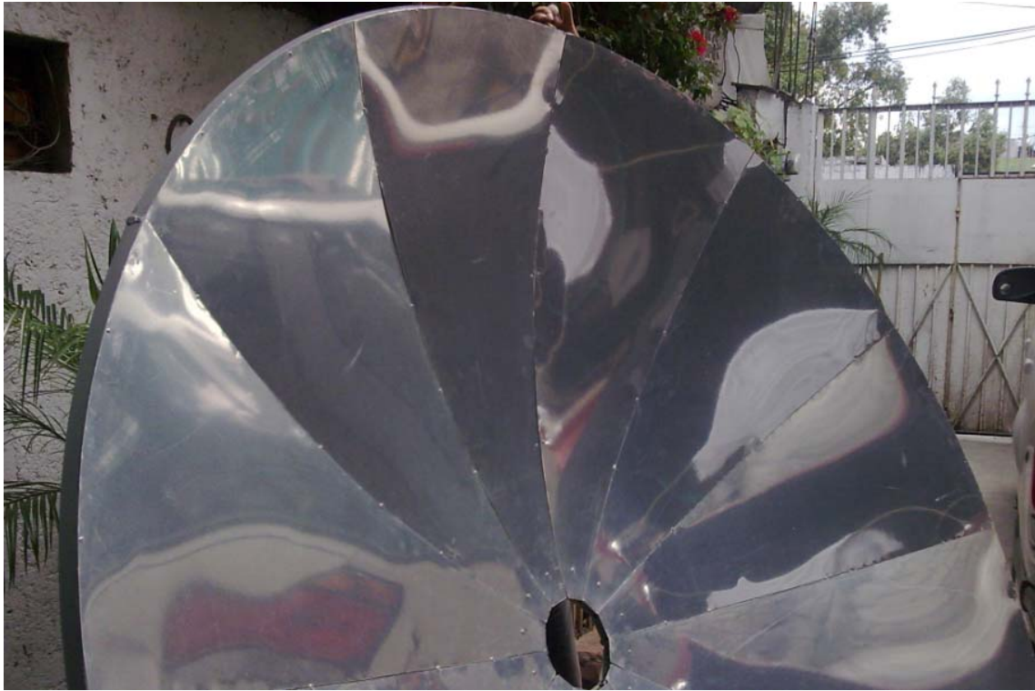
Ilustración 133. Paraboloide final con material reflejante Reflec Tech.
