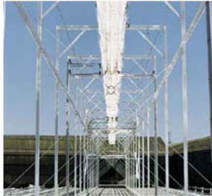
Ilustración 24. Concentrador tipo Fresnel (Pillatowsky, 2009).
