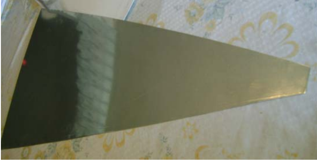
Ilustración 132. Reflec Tech pegado al sustrato de aluminio.
