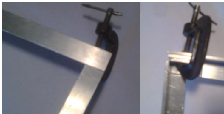
Ilustración 120. Sujeción en esquinas.
