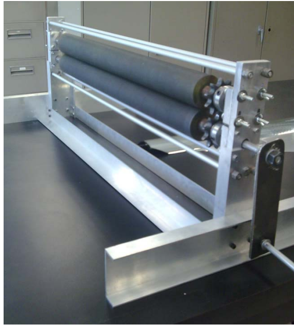
Ilustración 109. Laminadora diseñada para la aplicación de la película.
