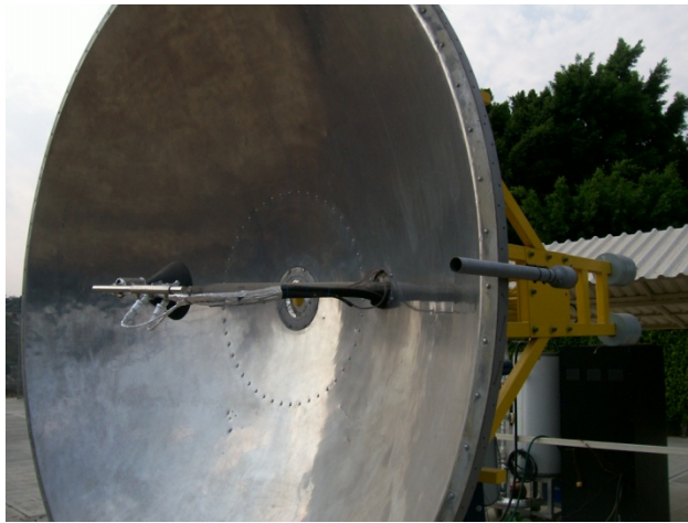
Ilustración 54. Concentrador solar de disco parabólico, construido en el Instituto de Energías Renovables de la UNAM.
