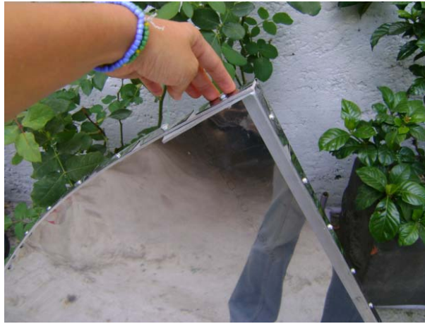
Ilustración 121. Muestra de esquinas en gajo terminado a 45 grados.
