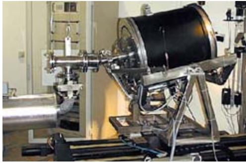
Ilustración 33. Prototipo de recuperación de aluminio mediante alta radiación (German Aerospace Center, 2009).
