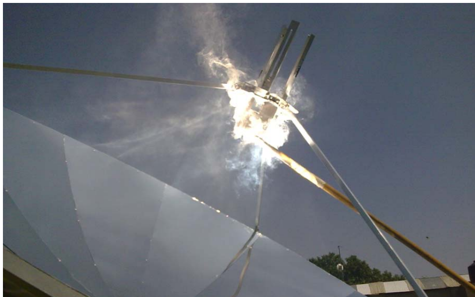
Ilustración 143. Alcance de temperatura para quemar madera.
