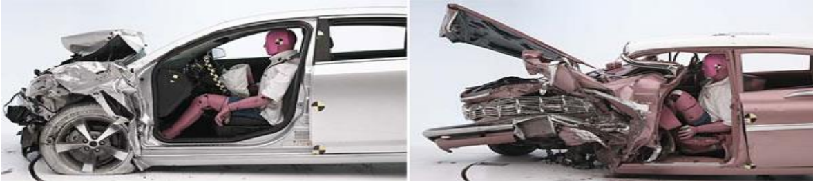
Figura 1.11 Comparación de habitáculos de pasajeros entre Chevrolet Malibú 2009 y Chevrolet Bel Air 1959 después de un choque. [14]
