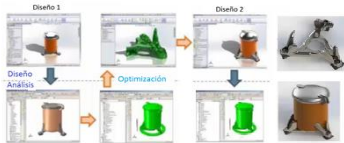
Figura 2.11 Ciclo de optimización mediante el módulo de optimización en Abaqus®. [19]
