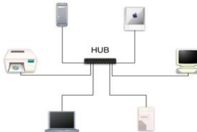
Figura 2.4 Esquema del funcionamiento de un hub
