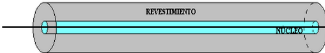
Figura A.12 Interior de la fibra monomodo
