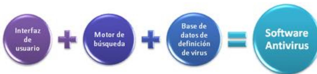
Figura 6.7. Partes de un software antivirus
