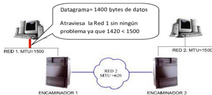
Figura 2.17 Se transmite un datagrama de 1420 bytes que sale del ordenador A y atraviesa la red 1 sin ningún problema ya que el MTU es de una red Ethernet y es menor a 1500
