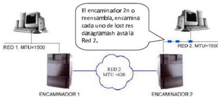
Figura 2.19 Ahora el datagrama original se divide en tres fragmentos que se convierten en un nuevo datagrama con el mismo identificador pero distinta información en los campos de desplazamiento de fragmentación y MF la cual es encaminada en el router 2.
