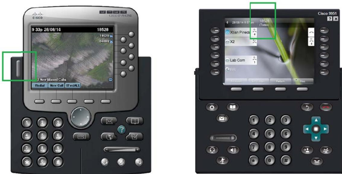
*Figura 3.33. Foco de alerta apagado antes de dejar el mensaje*
