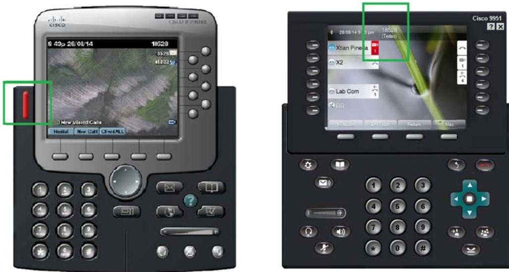
Figura 3.35. Foco de alerta encendido después de recibir el mensaje
