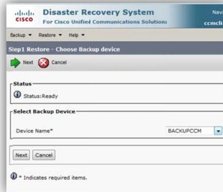
Figura 3.48. Carga de respaldo, seleccionando servidor
