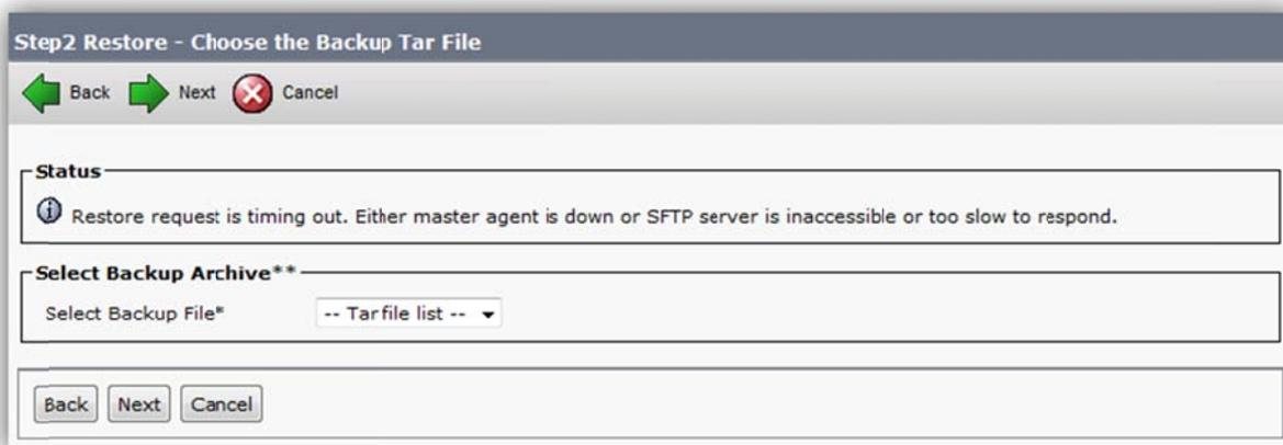
Figura 3.39. Carga de respaldo de CUCM original en CUCM de transición
