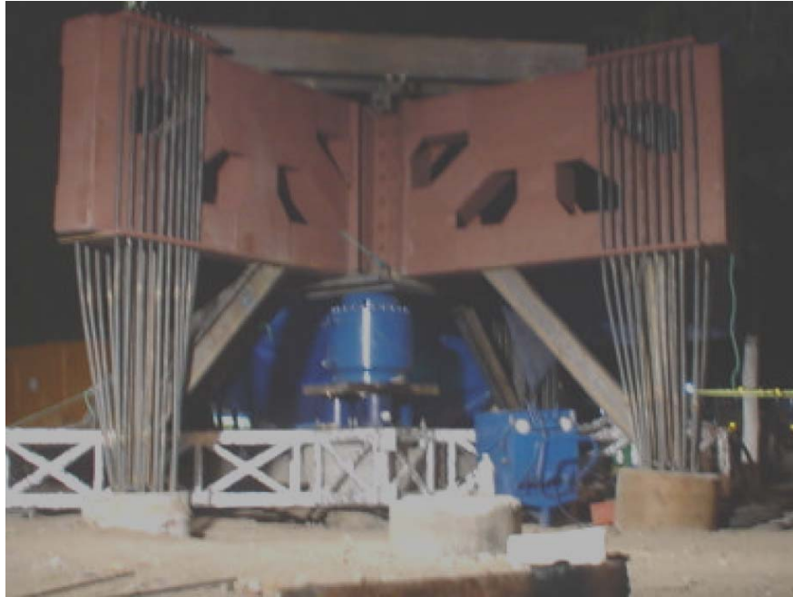
Fig. 1.4. Configuración en campo de un arreglo de prueba de carga
