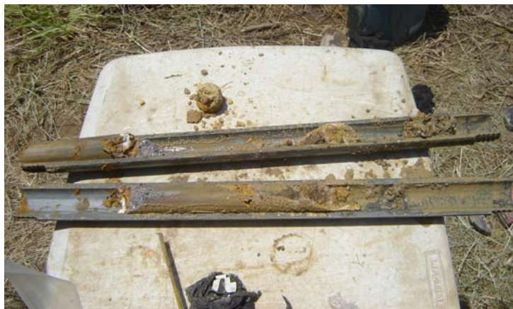
Figura 1.2. Recuperación de muestras alteradas por medio del tubo de pared gruesa partido longitudinalmente
