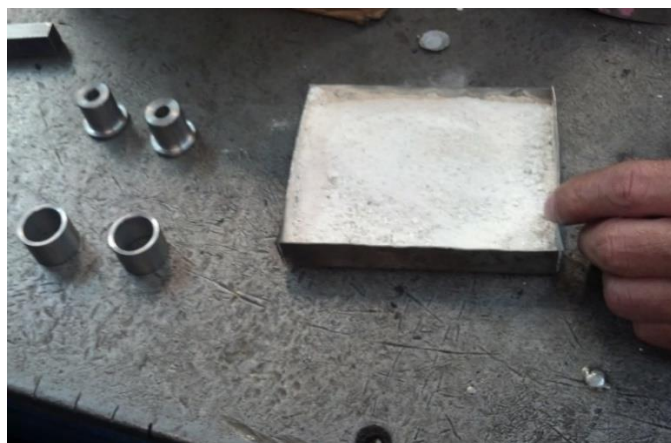
Figura 7.41 Piezas a cementar con cianuro.
