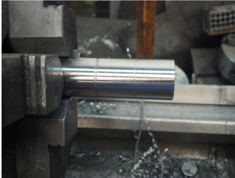
Figura 7.38 Realización de marcas en barra de acero.
