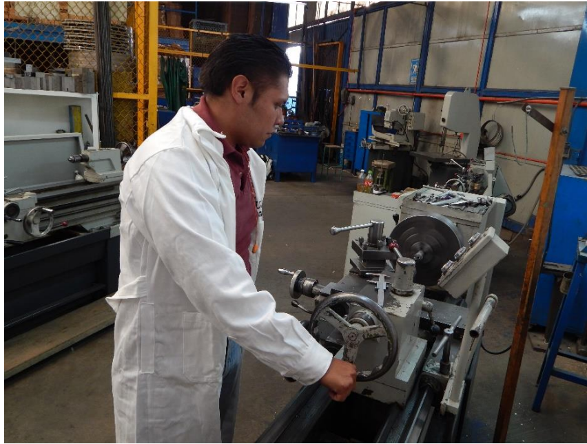
Figura 7.32 Torneado de barra de acero para buje macho
