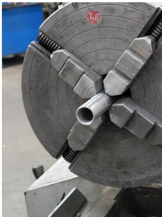
Figura 7.37 Vista de barra de acero después de ser barrenada.
