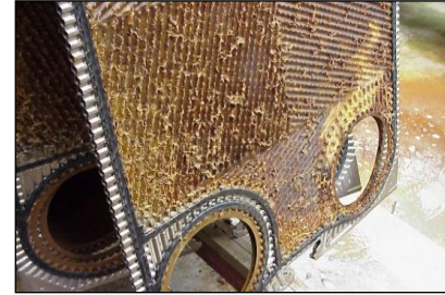
Figura 2.8 Ensuciamiento de un intercambiador (por corrosión)
