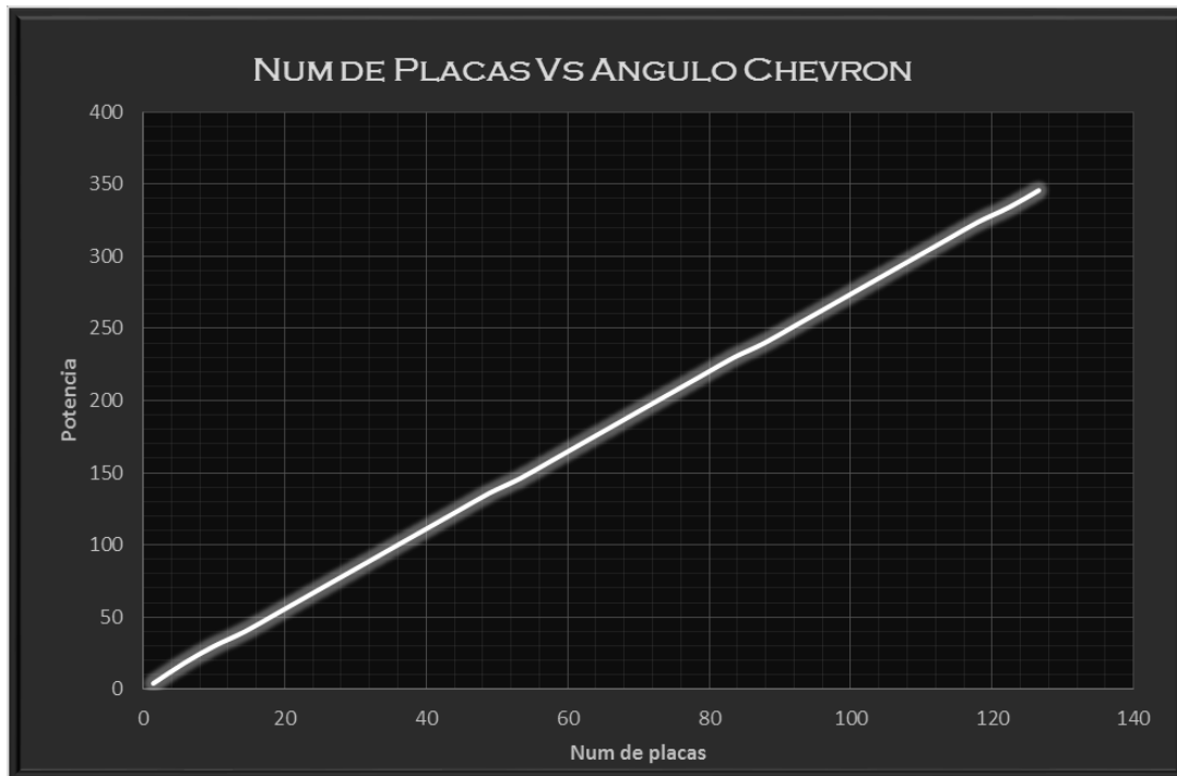
Figura 3. 11 Variación del área del intercambiador de calor de placas en función de la potencia requerida para el ciclo PWG, de acuerdo a un análisis no exergético.
