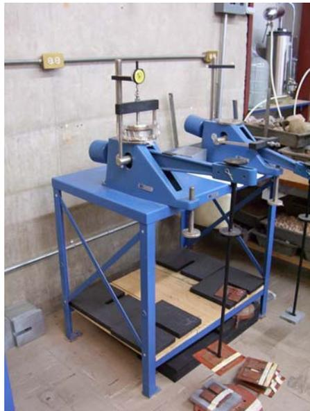
Foto 4.1 Consolidómetro mecánico.
