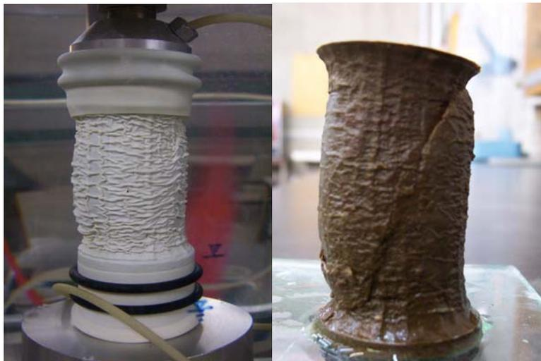
Foto 5.11. Probeta OCR = 6, 10 %/h
