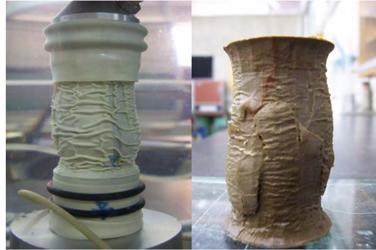
Foto 5.14. Probeta OCR = 8, 1 %/h
