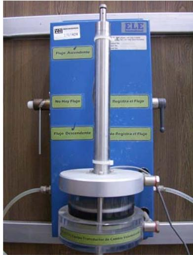
Foto 4.8 Transductor de cambio volumétrico.
