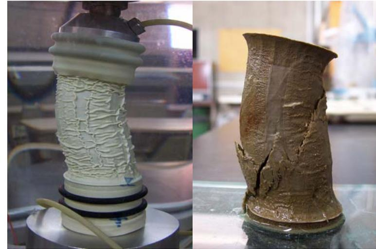
Foto 5.16. Probeta OCR = 8, 100 %/h
