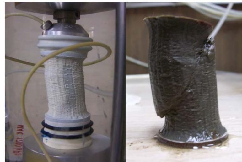
Foto 5.4. Probeta OCR = 1, 100 %/h
