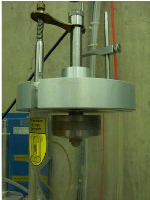
Foto 4.7 Transductor de carga sumergible.
