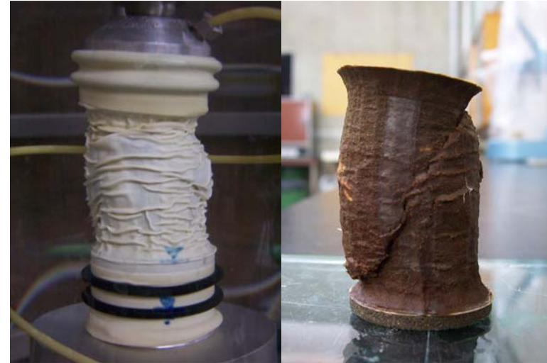
Foto 5.18. Probeta OCR = 11.8, 1 %/h
