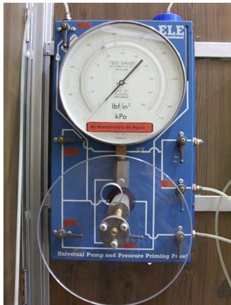
Foto 4.3 Bomba universal y mecanismo de presión.
