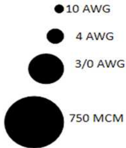
Figura 3. Secciones transversales de conductores comunes (tamaño real)
