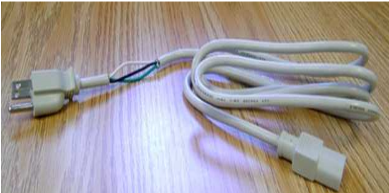
Figura 49. Se muestra el corte realizado en el cable de alimentación del equipo de cómputo
