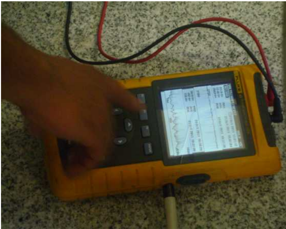
Figura 48. Dispositivo analizador eléctrico avanzado Fluke 43
