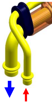
Figura 3.4 Línea de entrada (Derecha) – Línea de Salida (Izquierda).
