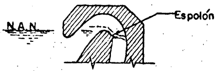
FIG. 13.-CIERRE HIDRAULICO POR LA LAMINA VERTIENTE.
