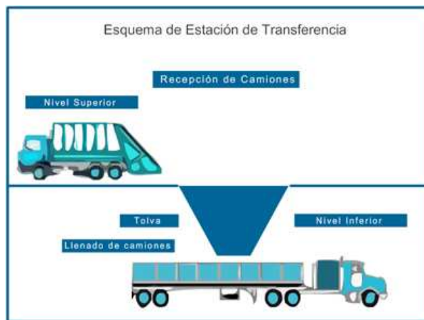
Figura 3.10 Esquema de estación de transferencia.
