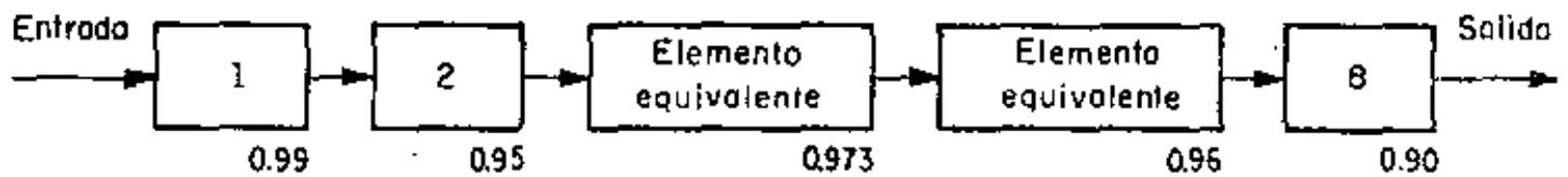
Fig 3.13 Sistema en serie equivalente al de la fig 3.12
