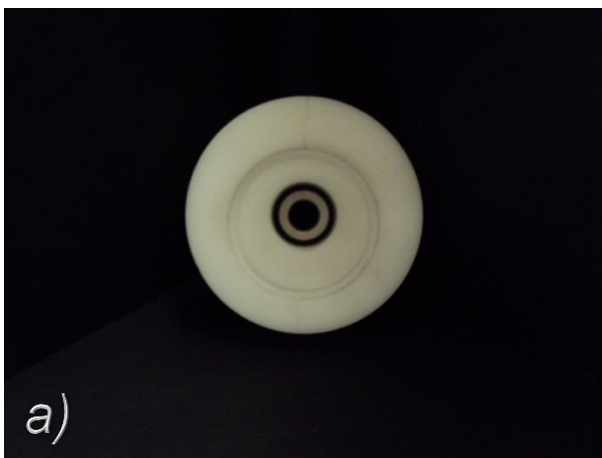
Figura 4.23 a) Se muestra la caja excéntrica en la carcasa del rotor, b) Se muestra la tapa de bomba terminada.
