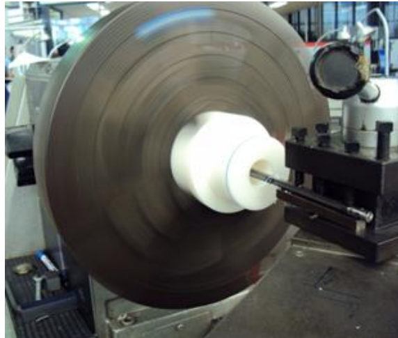
Figura 4.20 Maquinado de la perforación en la carcasa con la herramienta de interiores.
