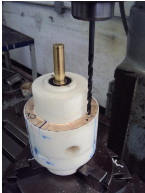
Figura 4.35 Manufactura de los barrenos en el cuerpo de la bomba.
