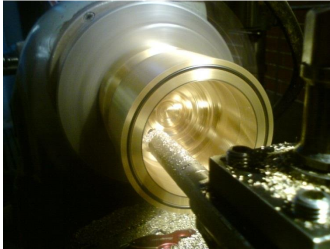
Figura 4.14 Se aproxima el diámetro interior con la herramienta de interiores.
