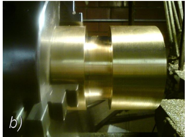
Figura 4.15 a) El interior del anillo está próximo a la medida que se requiere para llevarse al centro de maquinado CNC. b) La imagen muestra la garganta para desprender el anillo de la base.
