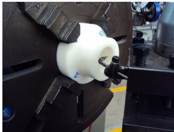
Figura 4.21 Herramienta de interiores haciendo la rosca en la carcasa.
