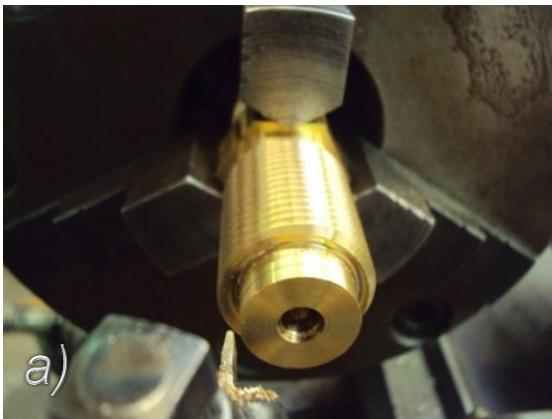
Figura 4.25 a) Corte de la caja del oring, b) Conector terminado con los dos orings montados.
