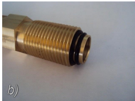
Figura 4.25 a) Corte de la caja del oring, b) Conector terminado con los dos orings montados.
