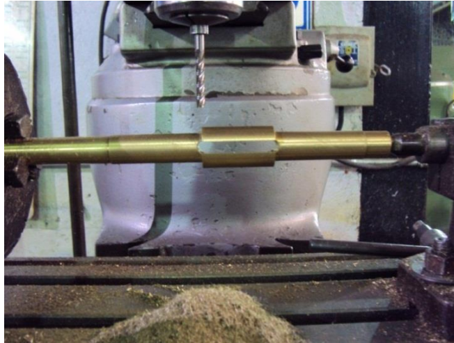
Figura 4.4 Ranura terminada en la flecha motriz.
