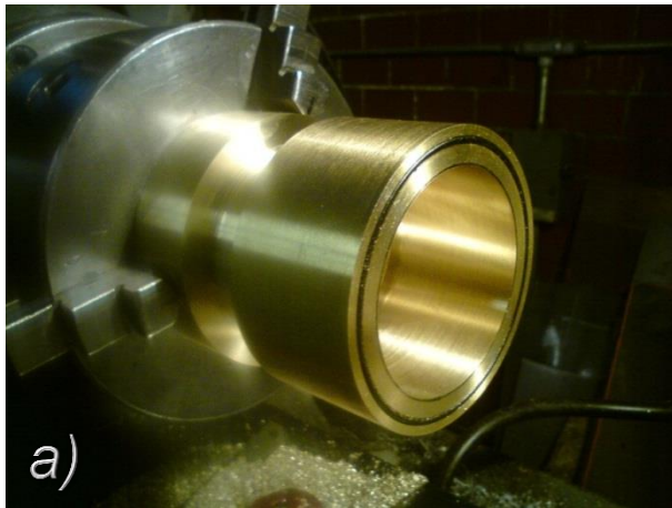
Figura 4.15 a) El interior del anillo está próximo a la medida que se requiere para llevarse al centro de maquinado CNC. b) La imagen muestra la garganta para desprender el anillo de la base.
