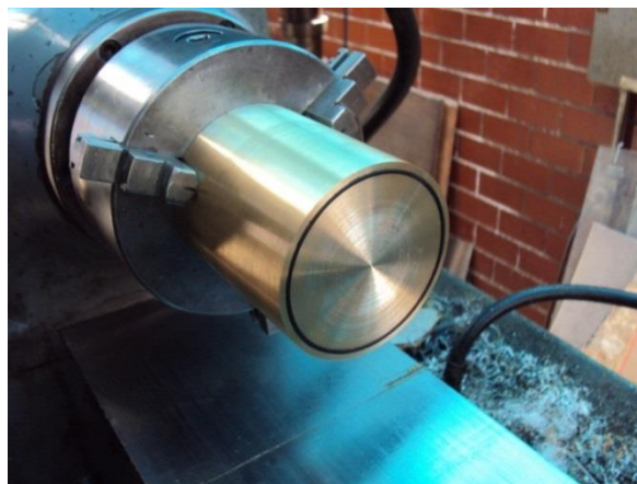
Figura 4.13 Tocho de latón cilindrado y refrentado en torno.
