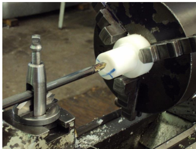
Figura 4.5 Operación de corte en una parte del rotor con la herramienta de interiores.
