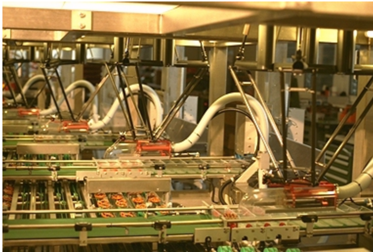
Fig. 1.1 Instalación del Demaurex's Line-Placer para empaque de pretzels en una panadería industrial.
