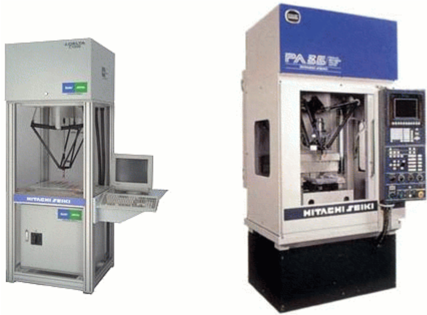
Fig. 1.3 Robots Delta Hitachi Seiki's Delta para tomar-y-colocar y taladrar.
