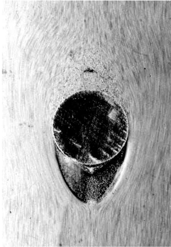
Figura 1.11: Fotografía de larga exposición, mostrando la interacción entre un flujo granular y un cilindro. Nótese la zona de estancamiento y la región sin material aguas abajo. Tomada de Brennen, Fundamentals of Multiphase Flow [40], con permiso de R.H.Sabersky.
