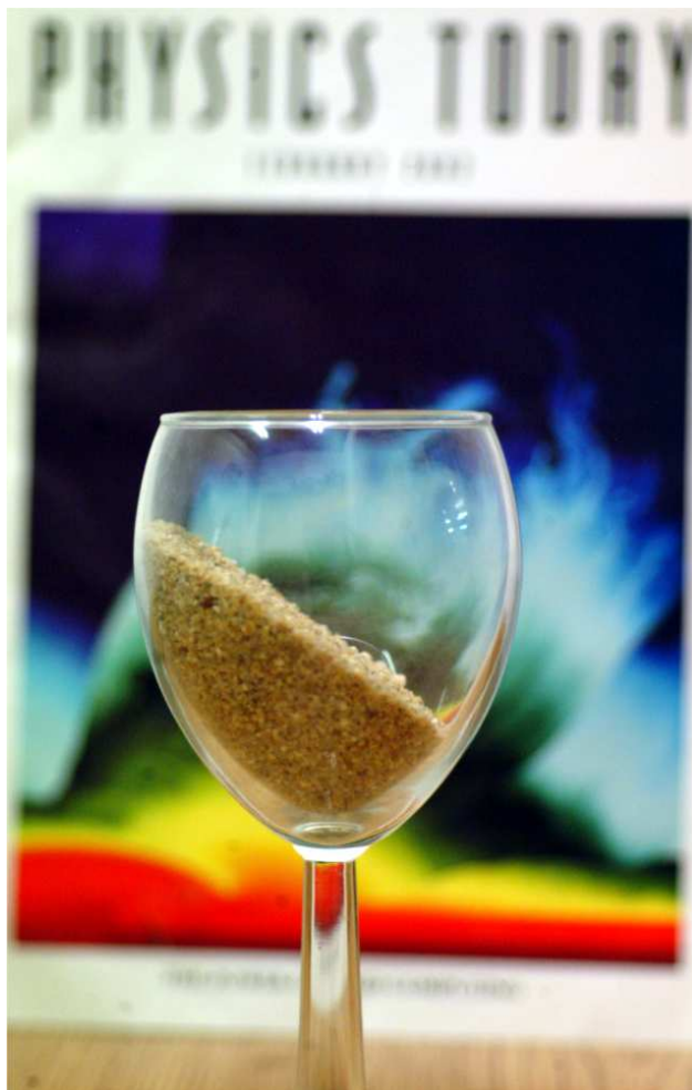
Figura 1.2: A diferencia de los fluidos convencionales, un medio granular en equilibrio no necesariamente presenta una superficie libre horizontal.
