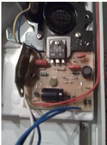
Figura 4.4.4 Módulo de potencia comercial para actuador piezoeléctrico.
