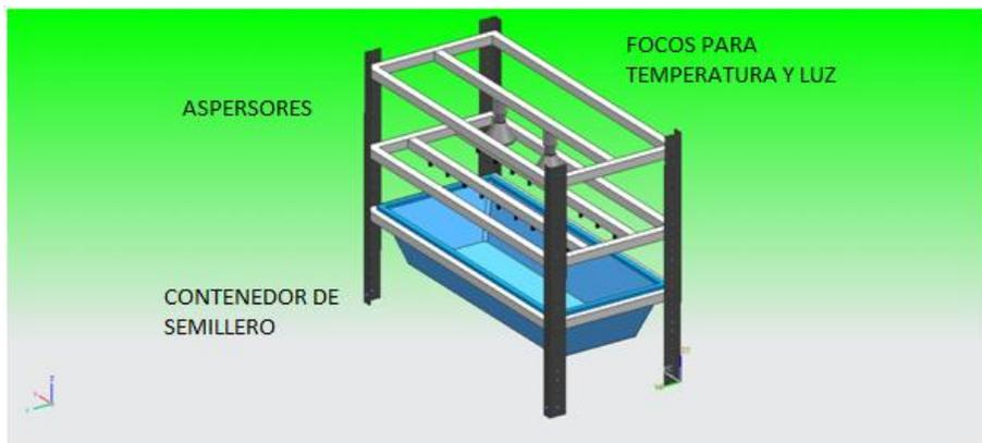
Figura 4.3.2.21 Estructura básica de módulo germinador de plántula.
