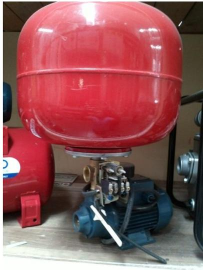
Figura 4.3.1.6 Bomba centrífuga.
