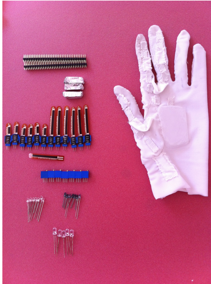
Figura 2.12. Guante instrumental, sensores optoelectrónicos, piezoeléctricos y potenciómetros.
