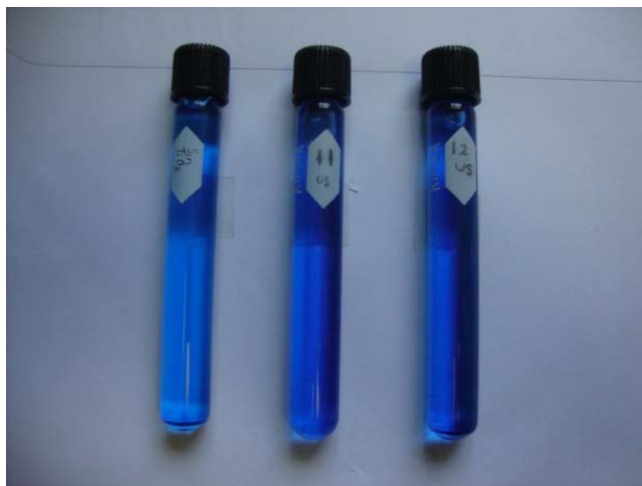
Figura 61. Tubos con disolución de azul de metileno para evaluar la actividad fotocatalítica.
