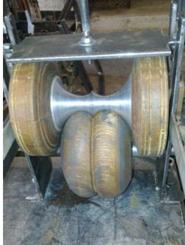
Figura 86. Dispositivo para doblado de las láminas reflejantes.
