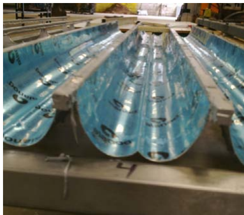
Figura 87. Láminas dobladas y montadas sobre los perfiles de aluminio.
