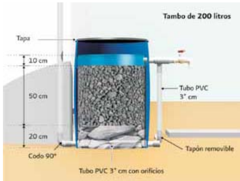
Figura 32. Filtro de grava para sedimentos. Fuente: CONAFOR.
