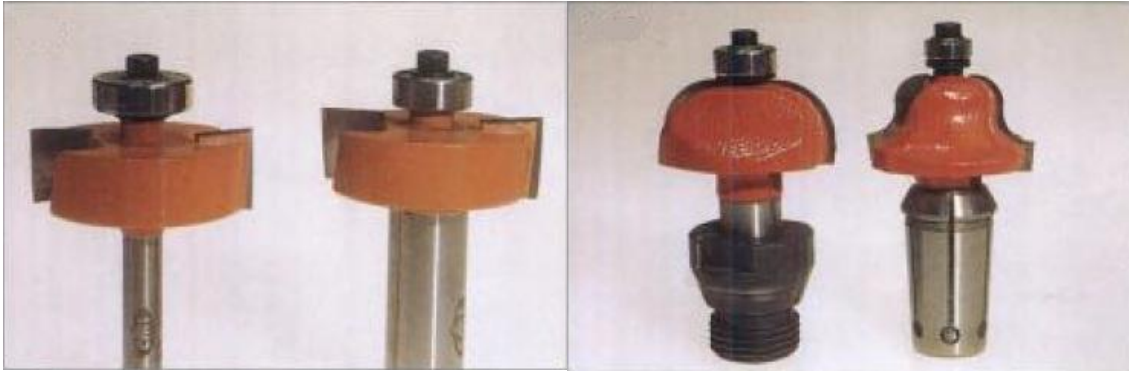
Figura 1.10. Herramientas de corte para madera con diferentes tipos y diámetros de zanco. Imágenes de Patrick Spielman, “The Art of the Router, Award Winning Design”, Sterling Publishing Co. Inc., pp. 10, 1998.
