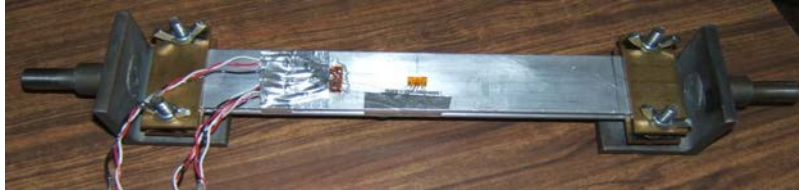
Foto 4.5 Ubicación de la roseta de deformación en la viga en I de Aluminio, localizada en el centro del eje longitudinal de la superficie.
