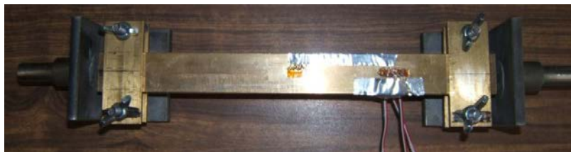
Foto 4.4 Roseta pegada en la probeta de la sección transformada, viga en I de Latón.
