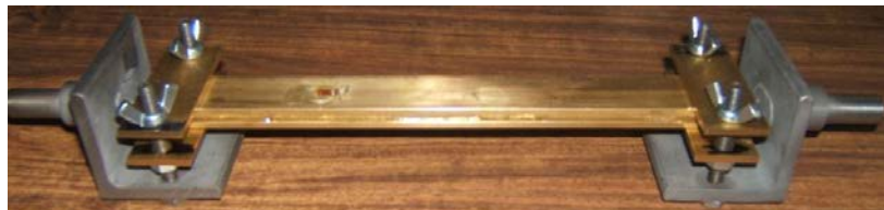
Foto 4.4 Sujeción de un espécimen de probeta previo a la prueba de torsión.
