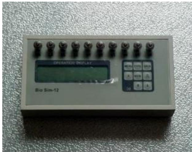
**FIGURA 63: Equipo Comercial Generador de Señal ECG**
