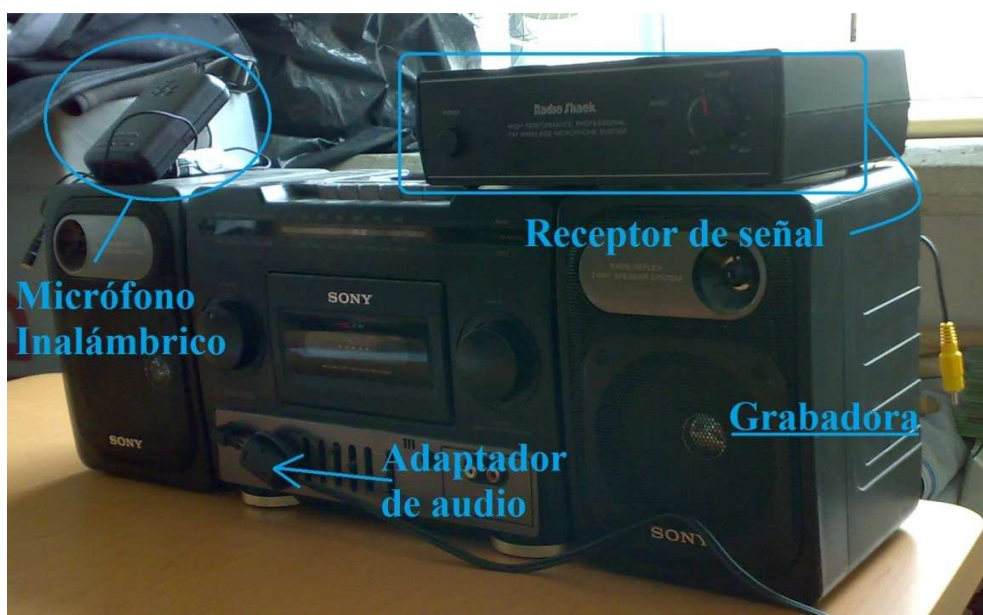
Figura A-1. Equipo utilizado en la medición del caudal de descarga de la DICyG
