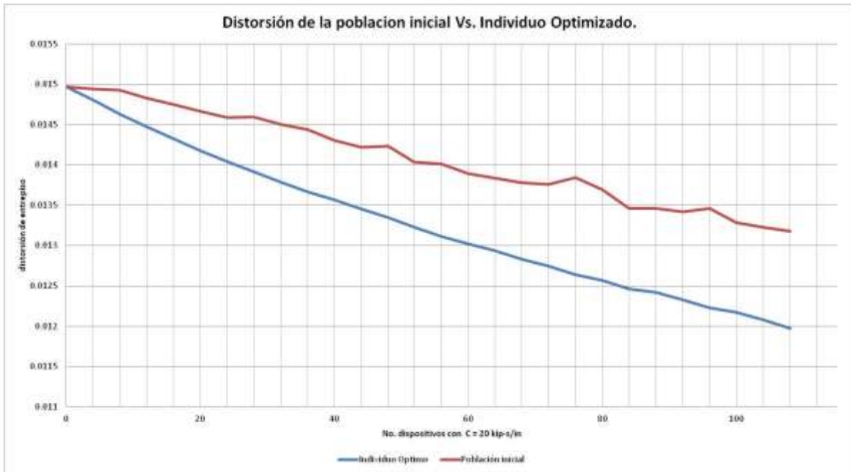
Figura 4.10. Comparación de la distorsión de la población inicial y distorsión del individuo optimizado después de 200 generaciones con dispositivos conectados a la estructura abarcando un entrepiso.
